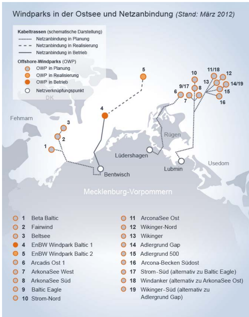
Abbildung 2: Geplante und bestehende Netzanbindungstrassen und Stationen von OWPs in der Ostsee. Der Abstand der Kabel beträgt offshore ca. 35 m.
